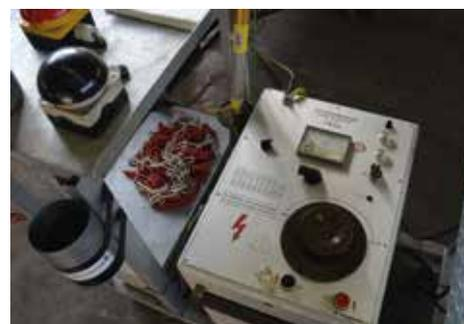
*Un générateur de tension de choc permet de localiser les points de haute ou faible résistance dans les câbles d'alimentation.*
